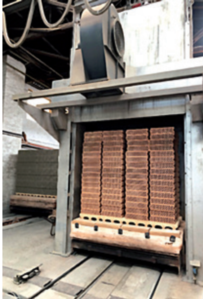
Abb. 12.10: Getrocknete (links) und gebrannte Ziegel (rechts) am Ofenausgang (Quelle: Ziegelwerk Ott).
