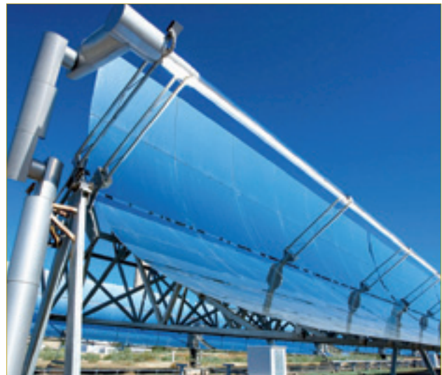
Bei Parabolrinnenkraftwerken wird die Sonnenstrahlung auf ein Rohr im Fokus des Spiegels konzentriert. Für solarthermische Kraftwerke werden verschiedene Techniken entwickelt, um die gesammelte Wärme zu speichern. (Foto: DLR)
