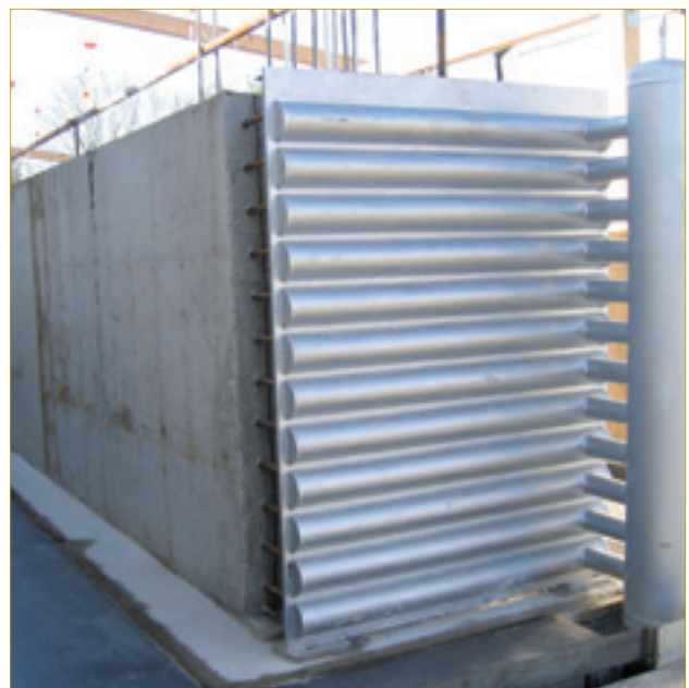
400-Kilowattstunden-Betonspeicher ohne Isolation. (Foto: DLR)
